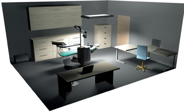
Obr. 3: 3D vizualizace situace z obrázku č. 1. Osvětlení nerespektuje další zrakové úkoly v ordinaci.
